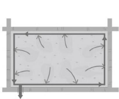
図:周囲溝のしくみ
